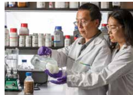
قام باحث في مركز أبحاث هيوستن التابع لأرامكو السعودية بوضع المعادلات الخاصة بسوائل للحقن في التكوينات الصخرية لإحداث شقوق يمكن للنفط أو الغاز أن يتسربا من خلالها ويخرجها من الصخور المحتجزين فيها.
